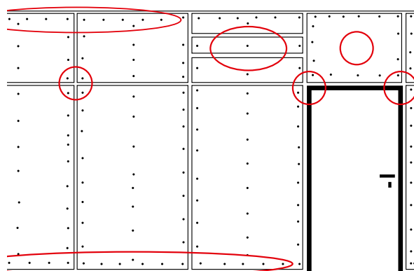
Typické příklady chyb při opláštění
