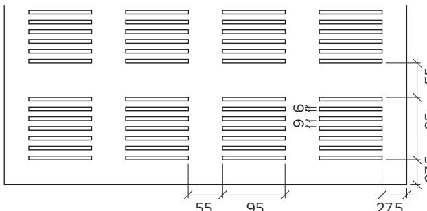
\* Tloušťka kazety s hranou B a D2 je 12,5 mm; další typy a rozměry na vyžádání.
