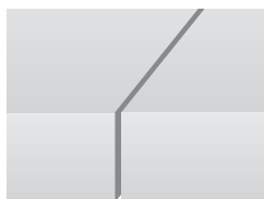
Spára na těsný sraz
