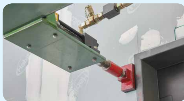
Statická zkouška ostění bezpečnostní příčky Habito H RC3
