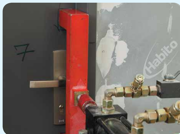
Statická zkouška dveřního křídla ATEX SAFE RC3 v místě bezpečnostního zámku
