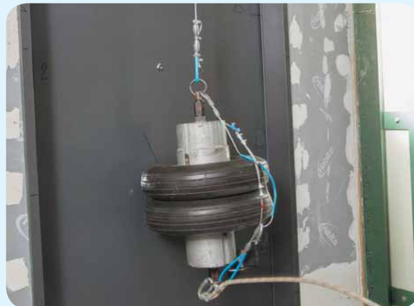
Dynamická zkouška dveřního křídla ATEX SAFE RC3
