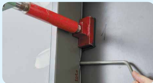
Statická zkouška dveřního křídla ATEX SAFE RC3
